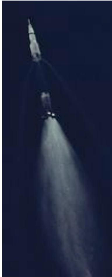
*Figura 7-11. Separazione del primo stadio del Saturn V di Apollo 11. Dettaglio della foto S69-39958.*
