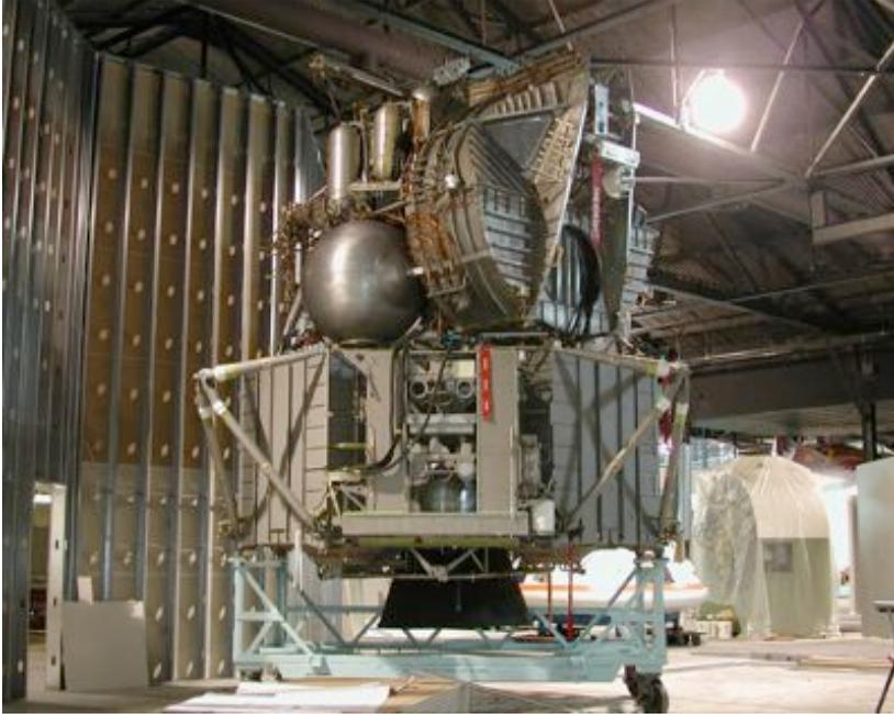
*Figura 7-22. Un prototipo del modulo lunare, custodito presso lo Smithsonian National Air and Space Museum, rivela la struttura metallica al di sotto del rivestimento termico. Credit: NASM, [www.nasm.si.edu](http://www.nasm.si.edu).*
