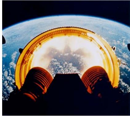
*Figura 7-20. Apollo 6: separazione dell'anello fra i primi due stadi. Fotogramma ripreso da una delle cineprese automatiche di bordo.*
