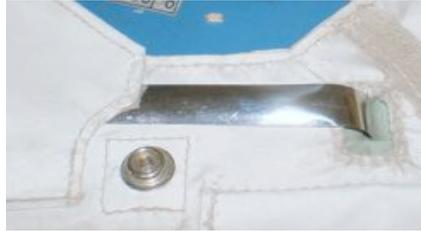
Figura 5-48. Dettaglio dell'antenna VHF di Charlie Duke (Apollo 16). Courtesy of K.C. Groneman and D.B. Eppler, NASA Johnson.
