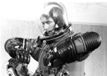
*Figura 8-21. Gene Cernan verifica la taglia dello strato ermetico della tuta spaziale, il Pressure Garment. Si notano le articolazioni a soffietto anche sulle dita.*
